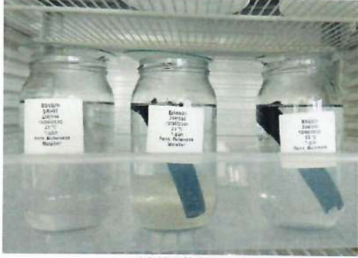
Şekil 3. 208/0356 no'lu "Sanica PE 100 Boru parçası" örneği(23°C)
